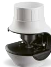
Objektiv mikroskopa sa LED propuštajućim i reflektovanim svetlom
